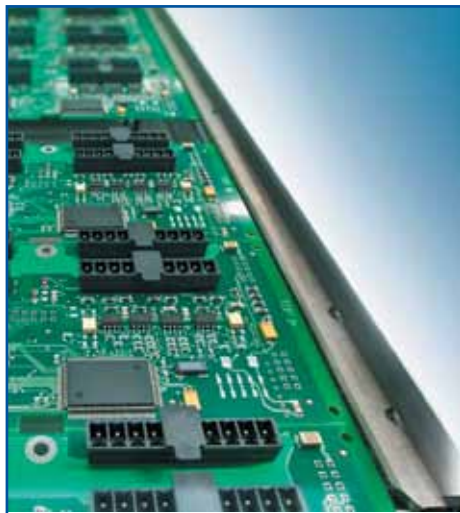
Рис. 14. Клеммы из LCP на плате с пластикой для захвата манипулятором
