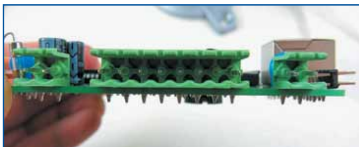
Рис. 6. Использование клемм WJ2EDGR на печатной плате
